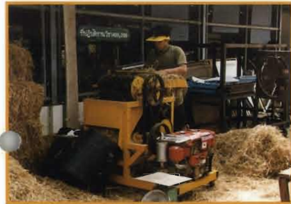
เครื่องสับพืชอาหารสัตว์เอนกประสงค์ใช้สับฟางข้าว
