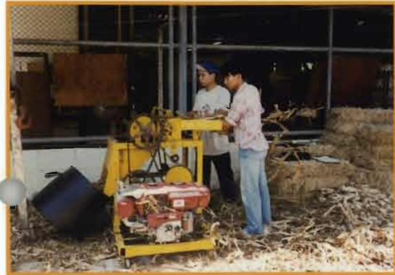
เครื่องสับพืชอาหารสัตว์เอนกประสงค์ใช้สับต้นข้าวโพด
